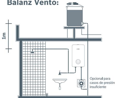
Para su arranque y óptimo funcionamiento, **la altura entre el tinaco y la regadera más alta debe ser mayor a 1m (100grs/cm<sup>2</sup> de presión de agua)**. Si no cuenta con la presión de agua necesaria, se recomienda adquirir una bomba presurizadora que le garantizará una excelente operación, máximo confort y agua caliente sin límites.
